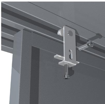
16. Сдвинуть дверь до упора вправо и аналогичным образом установить левый ролик.
