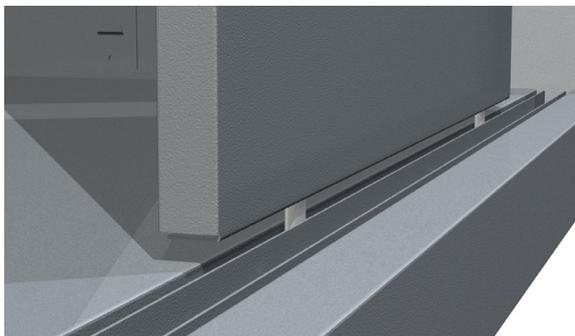
14. Сдвинуть дверь до упора влево. Отвинтить от кронштейна ролика П-образную опору. Максимально вывинтить нижний винт кронштейна. Установить правый ролик с кронштейном на дальнюю направляющую крыши.
