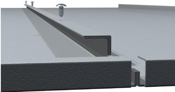
2. Установить дно, заведя отбортовку его задней части под нижние отгибы задних стенок. Боковые отгибы задних стенок при этом должны войти в соответствующие вырезы в дне.
