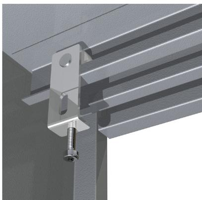
15. Расположить опору ролика под верхним отгибом двери таким образом, чтобы отверстие в отгибе двери совпало с резьбовым отверстием опоры. Сквозь овальное отверстие кронштейна ролика и отверстие двери завернуть винт в отверстие опоры (не затягивая до конца). Отрегулировать вертикальное положение двери с помощью нижнего винта кронштейна и зафиксировать кронштейн с помощью верхнего винта.
