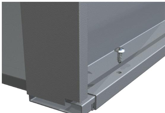
4. Немного приподняв дно, установить правую боковую стенку таким образом, чтобы ее задние отгибы оказались под отбортовкой задней стенки и вошли в пазы дна.
