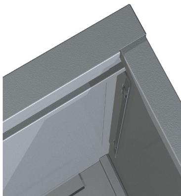
8. Вставить фасад кронштейнами в передние полости боковых стенок и задвинуть до упора.
