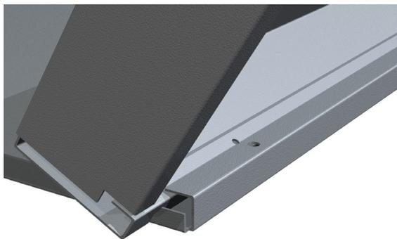
3. Прикрепить дно к задним стенкам с помощью четырех саморезов.
